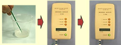
グミゼリーを咀嚼した際のグルコース溶出量を計測し、咀嚼能力を測定
